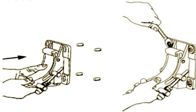
6) Analog zum ersten Halter (Basis) bestimmen Sie die Position der restlichen Wandhalter und montieren diese. Achten sie besonders darauf, dass alle Halter in einer Ebene und auf einer ebenen Wandfläche montiert werden.
