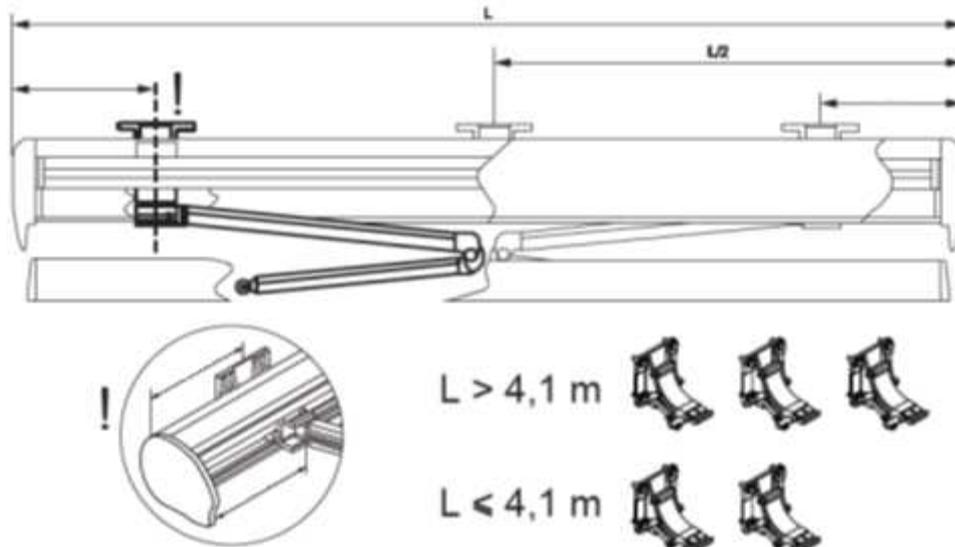
Die äußeren Wandhalter müssen an den vom Hersteller markierten Stellen im hinteren Teil der Markise montiert werden (so dass Sie sich in einer Achse mit den Gelenkarmhaltern befinden).
