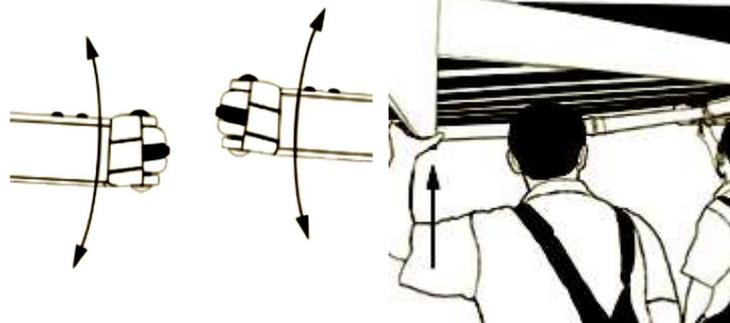
14) Sollte eine Einstellung notwendig sein, nehmen Sie diese durch Herein-/Herausdrehen der unten abgeb. Schraube in den Gelenkarmen vor. Sollten Sie Einstellungen an den Gelenkarmen oder dem Neigungswinkel vornehmen, muss eine Person die Gelenkarme durch leichtes Nach-Oben Drücken entlasten.
