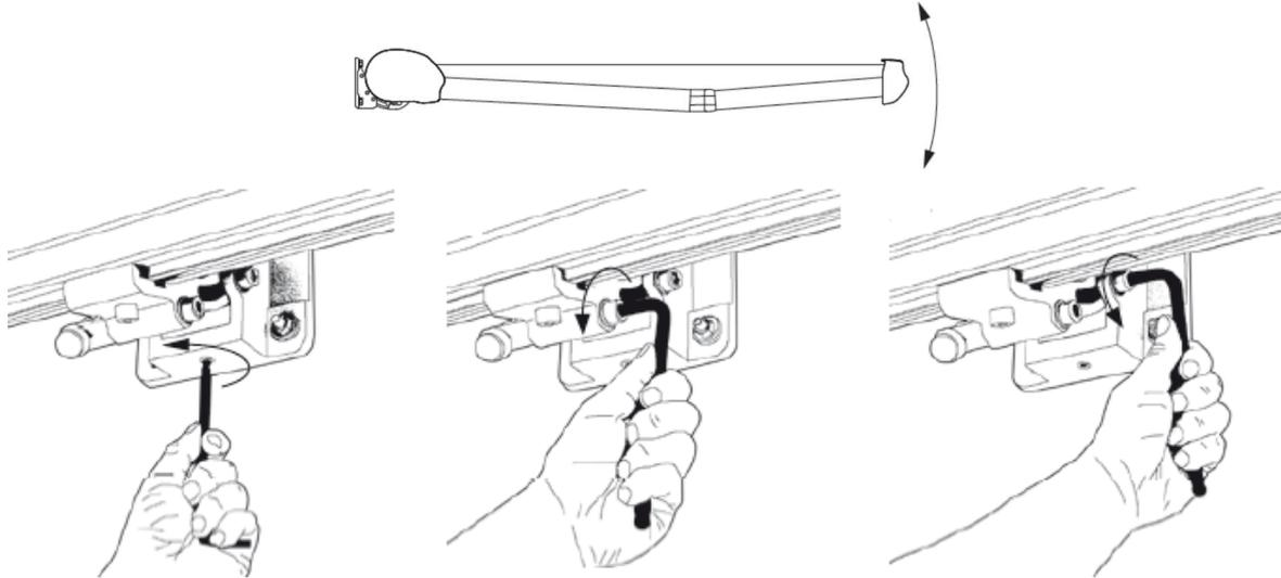
16) Mit einem Maulschlüssel verkleinern (Lösen der Sechskant-Schraube) oder vergrößern (Festziehen der Sechskant-Schraube) Sie den Neigungswinkel. Anschließend die Inbusschrauben wieder festziehen.
