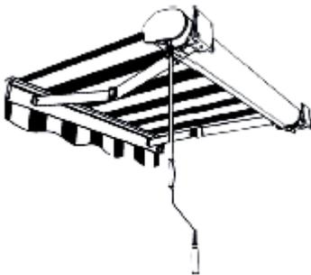
13) Prüfen sie mit Hilfe der Wasserwaage, ob die Gelenkarme in einer Ebene zueinander schließen.
