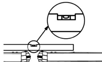
15) Wenn Sie den Neigungswinkel der Markise ändern wollen, müssen Sie die Markise zunächst komplett ausfahren. Anschließend müssen Sie die Schraube unten am Halter und die seitlichen Inbusschrauben M10 lösen, die den beweglichen Teil des Halters sichern.
