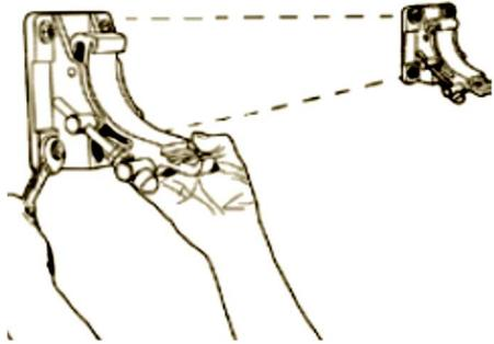
10) Hängen Sie die Markise in die Halter, so dass die Kassette maximal an die Halter gedrückt wird (Achtung – vor dem Einhängen ist zu prüfen, ob alle Halter sich im Lot befinden und auf einer ebenen Fläche montiert sind).
