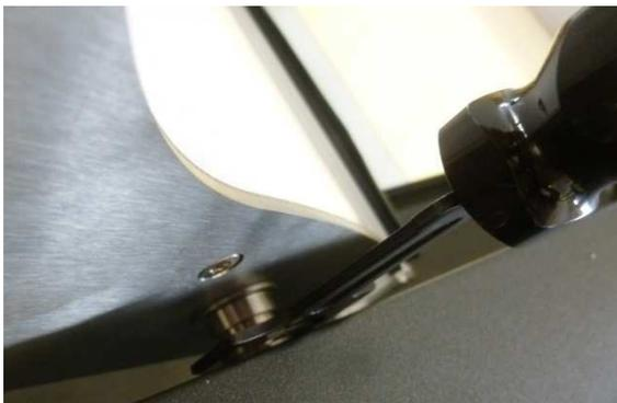
1. Stecken Sie den Sicherungsclip auf einer Seite in die mittlere Rille am Bolzen – ist die Antriebsseite abgebildet. Wiederholen Sie dies für jede Lamelle **auf der gleichen Seite** (Zeichn. 24).
