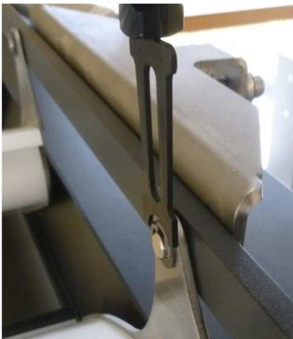
4. Montieren Sie die Zugstange an den Lamellen. Beginnen Sie mit der Motorhalterung. Drehen Sie die Lamellen so, dass die Öffnungen der Lamellenendkappen mit denen in der Motorhalterung übereinstimmen. Stecken Sie den Splint von der Motorseite soweit in die Öffnung (von der anderen Seite ist es auch zulässig) bis die äußere Rille sichtbar ist. Setzen Sie den kleinen Sicherungsclip ein (Zeichn.30). Wiederholen Sie diese Tätigkeit für den anderen Splint der Motorhalterung.
