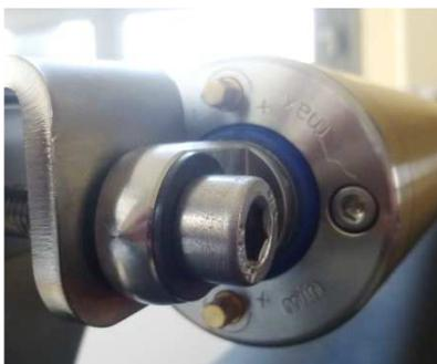
**ACHTUNG:** Die Einstellung der Endlagen ist ausschließlich manuell mit einem Maulschlüssel vorzunehmen. **Die Nutzung eines Akkuschraubers kann zur Beschädigung der Endlageneinstellung führen.** Die Einstellung ist nur an der Endlage „max“ vorzunehmen. (Zeichn. 33).
