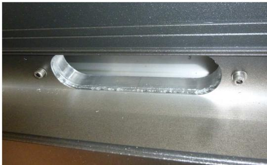
3. An den ovalen Ausschnitten sind an beiden Enden die rostfreien Inbusschrauben M5x20 mit Unterlegscheiben zu montieren (Zeichn. 18).
