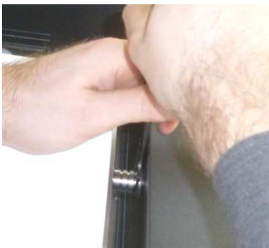
4. Setzen Sie die weiteren Lamellen in die Pergola ein: Heben Sie diese flach über die Pergola (Antriebsseite auf der Seite des Motors), schieben das Ende ohne Sicherungsclip auf dem Bolzen soweit es geht in das Lamellenlager, anschließend senken Sie die Lamelle auf der anderen Seite (mit Sicherungsclip) soweit, dass der Sicherungsclip sich an der seitlichen Strebe anlehnt. Setzen Sie nun den großen Sicherungsclip in die Rille die sich am nächsten am seitlichen Profil befindet (Zeichn. 26).
