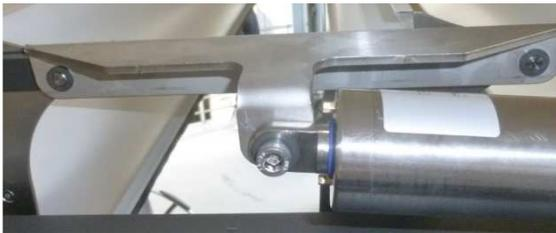
2. Setzen Sie in die Motorhalterung auf der Motorseite jeweils eine kleine Plastikhülse in beide Öffnungen (Zeichn. 28).
