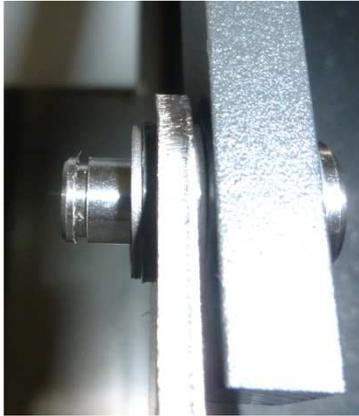
5. Bringen Sie die Zugstange an den restlichen Lamellen an. Stellen Sie die Öffnung der Lamellenendkappen auf der Antriebsseite so, dass Sie mit denen in der Zugstange übereinstimmen. Stecken Sie den Splint von der Motorseite soweit in die Öffnung (von der anderen Seite ist es auch zulässig) bis die innere Rille sichtbar ist. Setzen Sie den kleinen Sicherungsclip ein (Zeichn.31).
